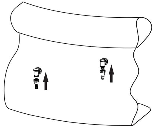
3) Brancher le flexible de 1,25 ou 1,5 po à l'adaptateur, puis serrer le collier de flexible.
