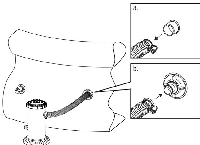
4) Serrer les colliers de flexible afin d'éviter que le tout se desserre et de prévenir les fuites d'eau. Répéter les étapes 2, 3 et 4. Brancher le raccord de retour à la sortie de la pompe à filtre (séquence montrée ci-dessous).
