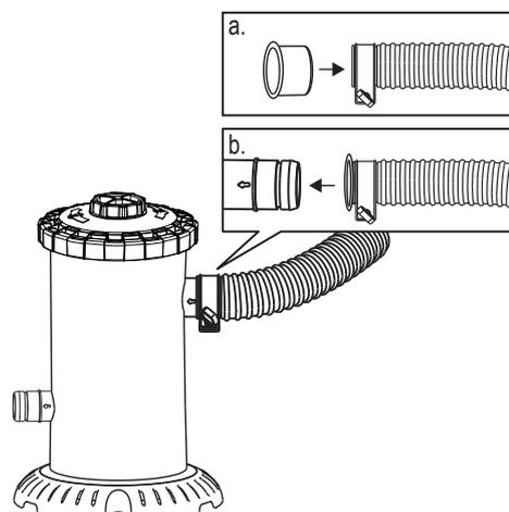
3) Insérer un autre adaptateur de boyau à l'autre extrémité du boyau, puis brancher le boyau au raccord d'aspiration de la piscine.
