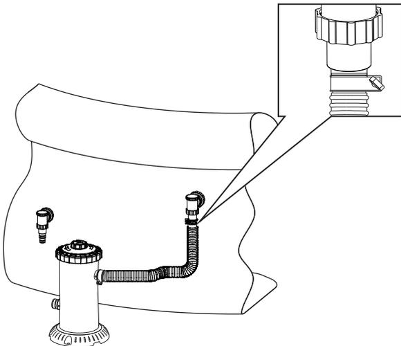
4) Brancher un autre flexible à l'autre adaptateur, puis serrer le collier de flexible.
