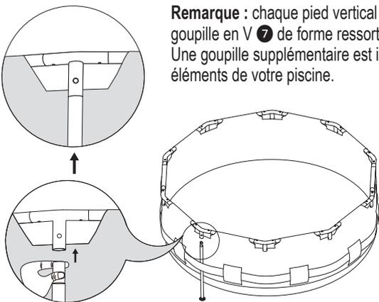
13. Faites le tour de la piscine et vérifiez que les jonctions, les pieds et les poutres sont tous correctement assemblés et fixés. Vérifiez que le raccord de vidange est solidement assemblé et que le bouchon est en place.
