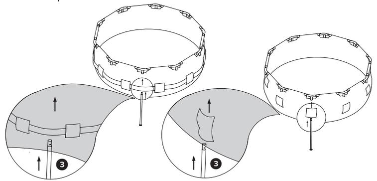
12. Observez le trou de la jonction en T pendant l'insertion d'un pied vertical et tournez le pied jusqu'à ce que les boutons s'alignent avec les trous et en ressortent en verrouillant la position du pied. Faites de même pour l'ensemble des pieds.
