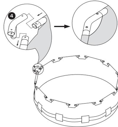
10. Insérez les goupilles ⑥ dans le haut des jonctions en T jusqu'à ce qu'elles s'encastrent dans la partie inférieure des jonctions.
